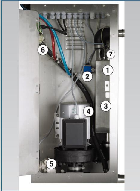
1. Système de chauffage instantané A0019513
